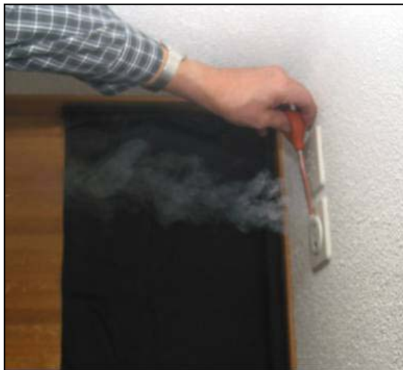
Abb. 1.2: Nachströmung durch die Abschlussdose des Kabelfernsehens im Schlafzimmer Luftvolumenstrom (geschätzt mit Flowfinder-Messung) ca. 2-3 m 3 /h
